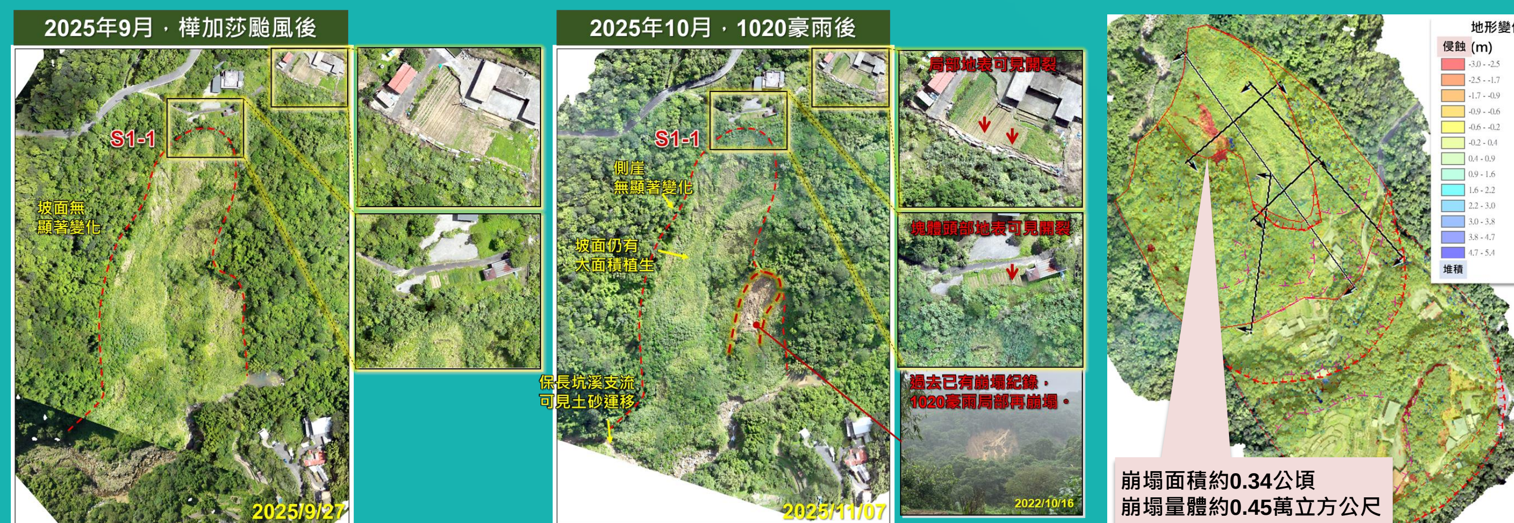
1020豪雨S1-1左側坡面，局部發生崩塌，深度約2~3m。整體崩塌範圍未擴大
