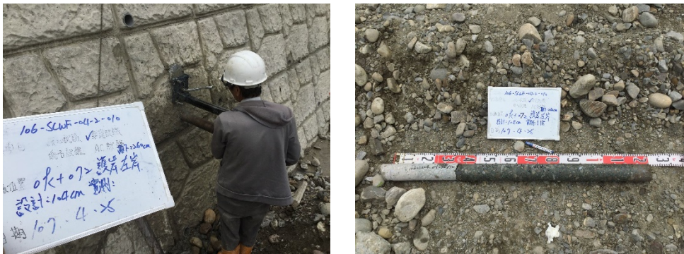
圖 2-17 構造物基礎厚度現場取樣及量測情形
