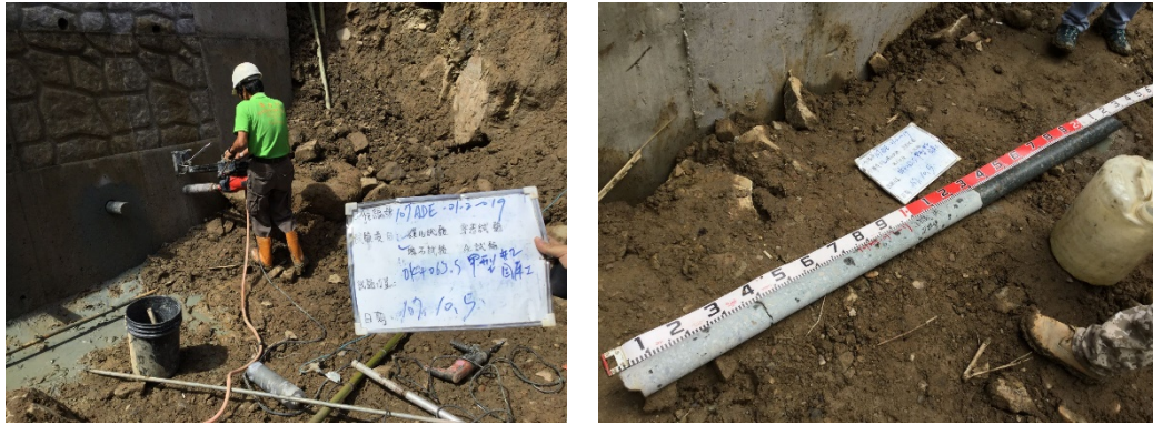
圖 2-18 混凝土構造物含塊(卵)石現場取樣及量測樣情形
