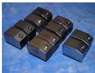
圖 2-22 斜束換能器 KGK 2Z20N
