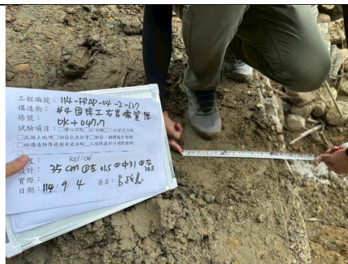
0K+047.7 #4 固床工(右翼) 頂厚設計 35cm；實際 30.5 cm、31 cm、31.5cm
