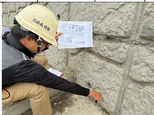
PVC 管壁厚度未符合設計尺寸設計尺寸 \geq 5\text{mm} ；實際值 3.5mm、3.5mm、3.5mm
