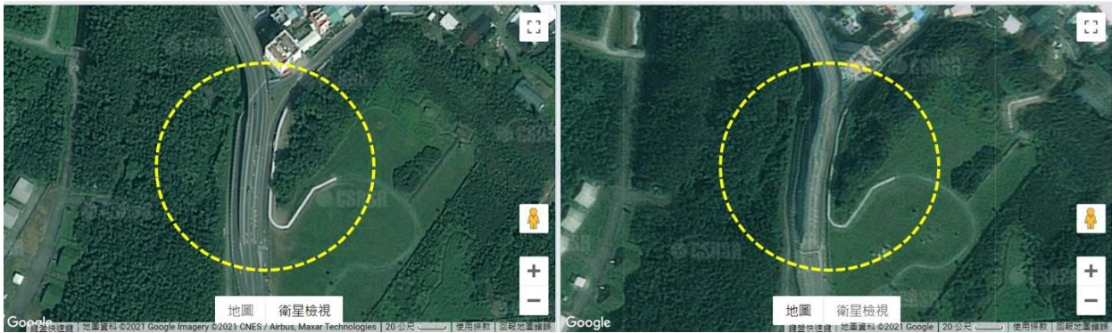
圖 2-5 2018 年花蓮地震，七星潭大橋災前(左)及災後(右)，橋面有明顯錯動與斷裂
