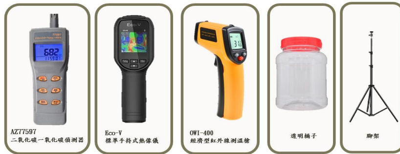
圖 2-10 水保工程碳排監測儀器
