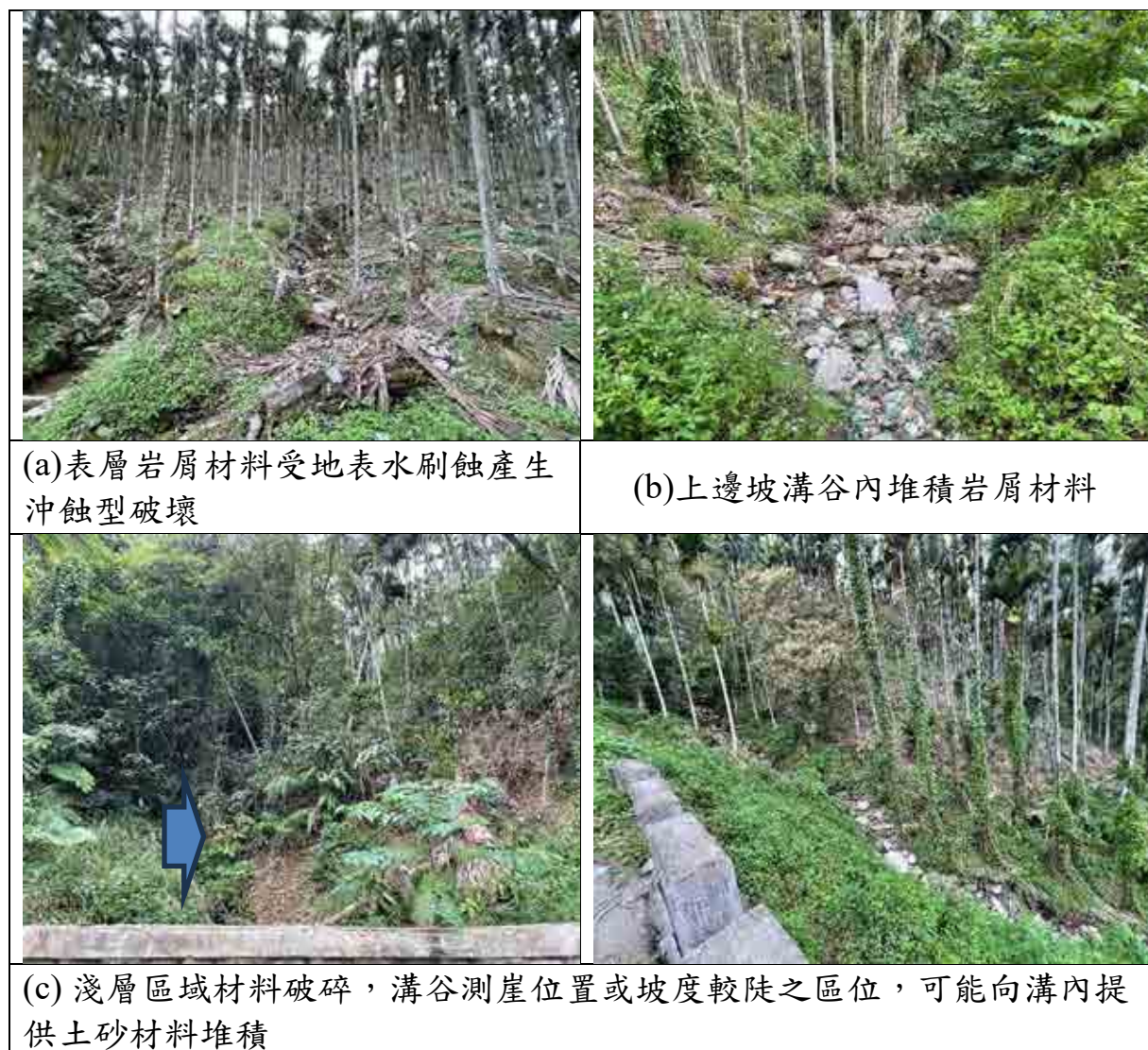
圖 4-84、溪頭調查區邊坡破壞機制示意圖
