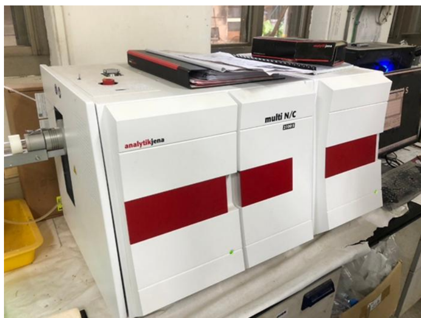
圖 2- 48 本計畫採用乾燥燃燒儀器照片(資料來源：本計畫製作)
