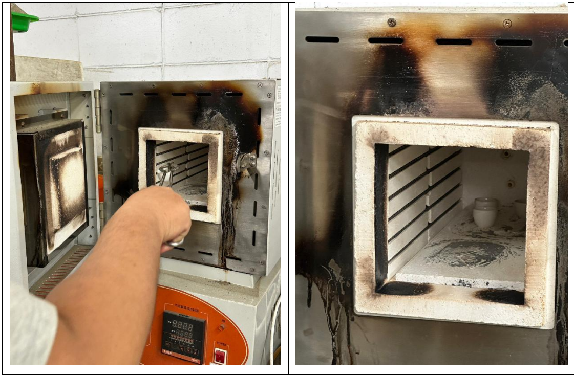
圖 2-2 熱損失量簡便測定法操作過程(資料來源：本計畫製作)
