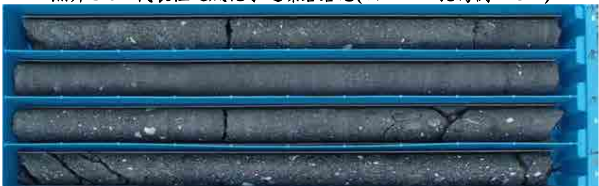
照片 3-7、代表性之水璣礫岩岩芯(以 A17-3 孔為例 16~20 m)
