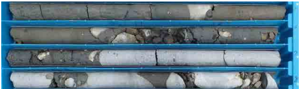
照片 3-6、代表性之風化水璣礫岩岩芯(以 A17-4 孔為例 4~8 m)
