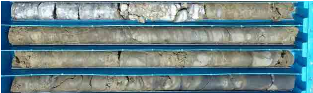
照片 3-5、代表性之岩屑層岩芯(以 A17-8 孔為例 0~4 m)
