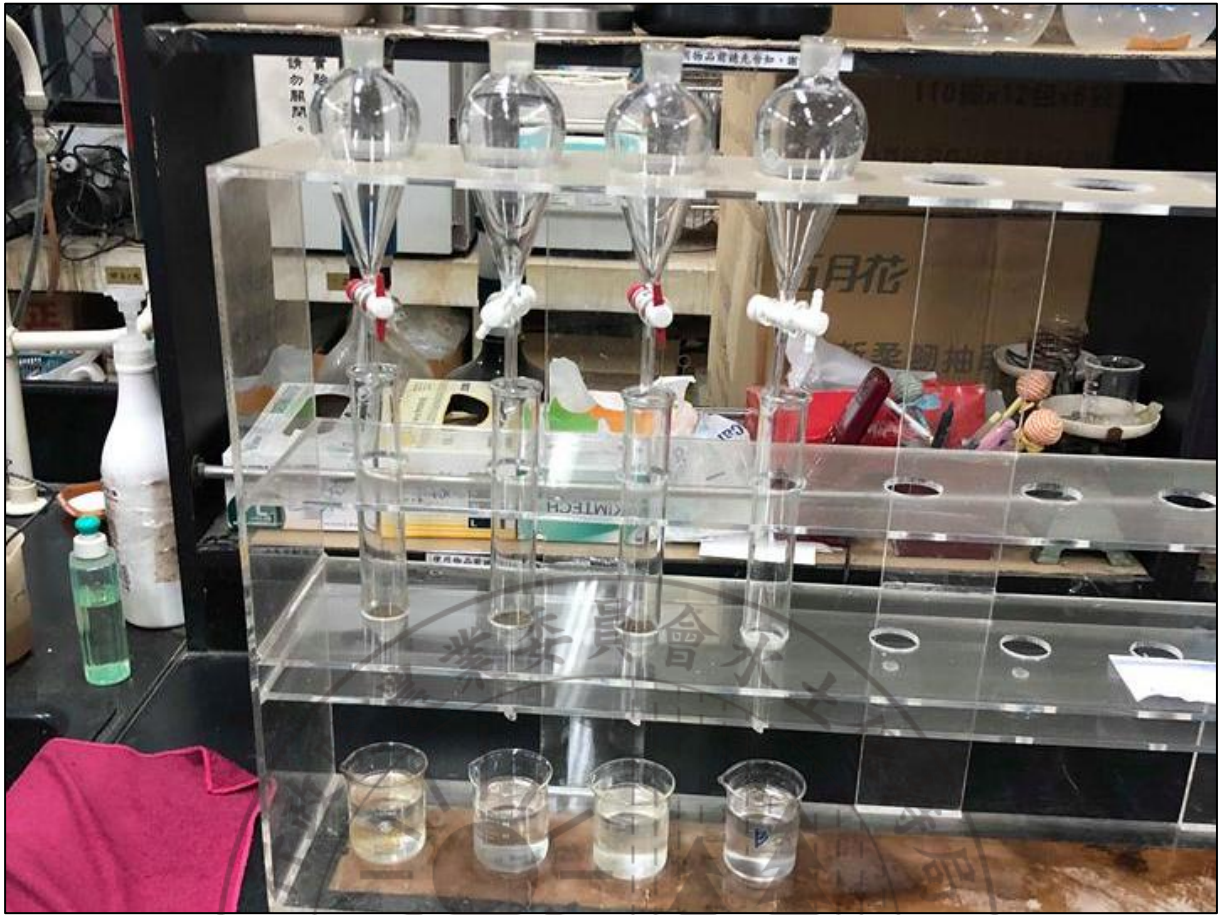
圖 3-22 以 1 M 醋酸銨淋洗土樣
