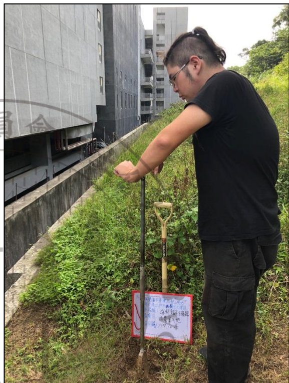
圖 3-14 土壤深度測定
