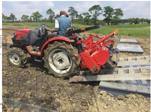
圖 3-6(h) 運用耕犁機將生物炭均勻攪拌
