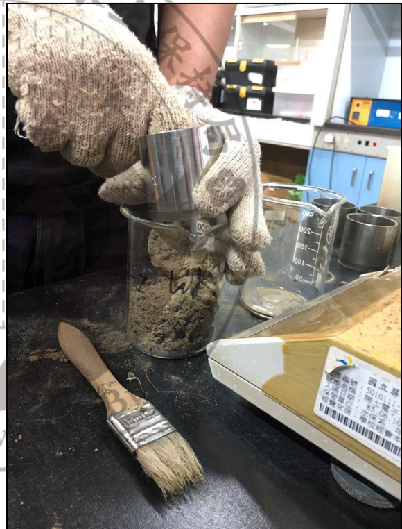
圖 3-24 將土環中的土壤推入燒杯
