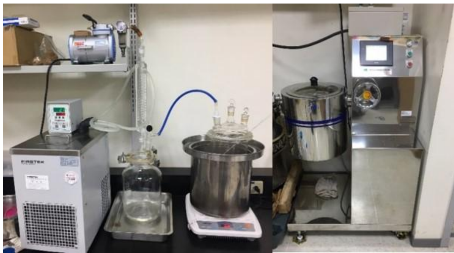
圖 45、多重壓差超音波萃取
