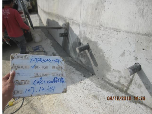
圖 2-12 各鑽心試體間距分布
