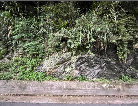
(F) 調查區硬頁岩出露情形，有明顯 風化情形(調查區外，台 7 線約 41.2K)
