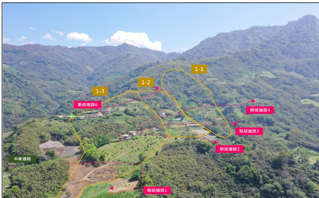
圖 3-32 本特定水土保持區滑動塊體分布示意圖
